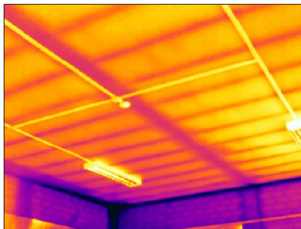
Foto n°7-8 - Individuazione della tramatura caratteristica dell'intradosso del solaio dell'Aula 5 al piano terra in cui è possibile riscontrare una scansione di travetti risultata costante ed uniforme sull'intera superficie dei plafoni.
