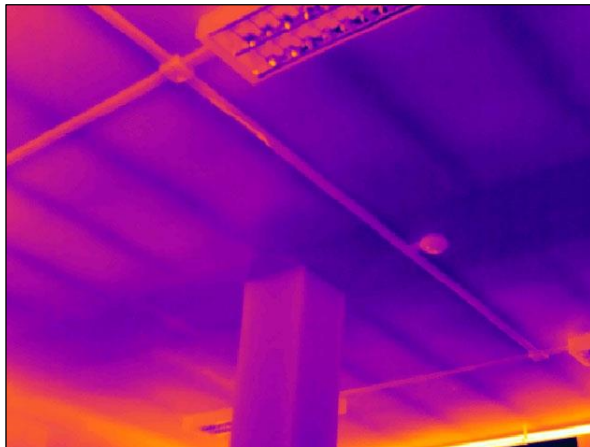
Foto n°11-12 - Individuazione della tramatura caratteristica dell'intradosso del solaio della Mensa al piano seminterrato. È possibile inoltre individuare il tracciato caratteristico di una trave confinata nello spessore del solaio.
