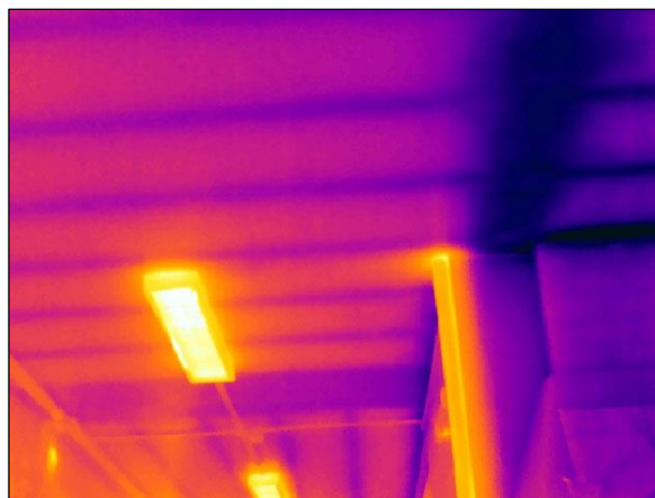
Foto n°9-10 - Nel Corridoio al piano terra è stato individuato il tracciato caratteristico di una trave confinata nello spessore dell'impalcato e si può notare la variazione di orditura del solaio.
