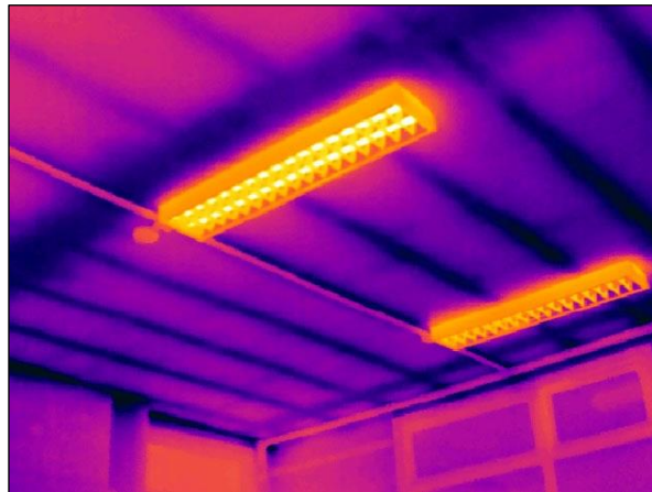
Foto n°5-6 - Individuazione della tramatura caratteristica dell'intradosso del solaio dell'Ingresso I al piano terra in cui è possibile riscontrare un elemento rompitratta che suddivide le campate in parti uguali.
