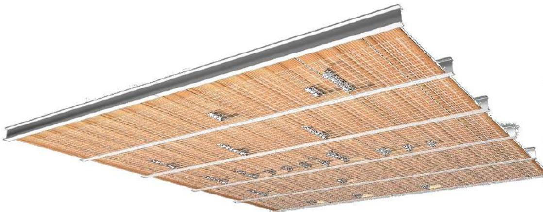
*Schema di posa rete antisfondellamento su solaio misti acciaio – laterizio*
